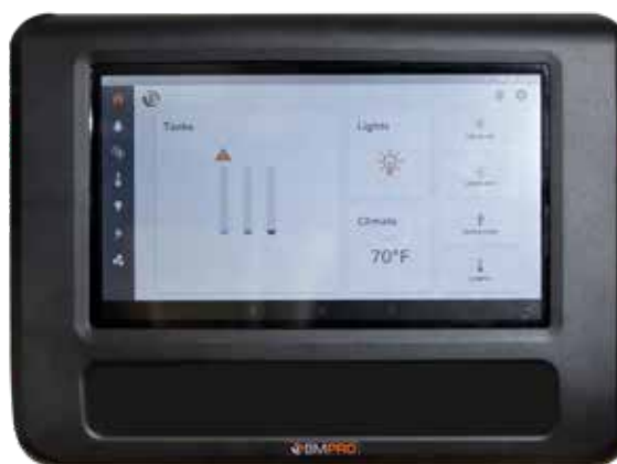
Autre écran tactile sans panneau de commutateurs, affichage des menus et boutons de navigation, référencés par le fabricant comme RVMasterController Lite.
