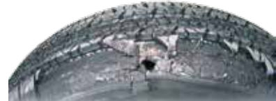
Le sous-gonflage et le surgonflage peuvent entraîner de graves défaillances des pneus
