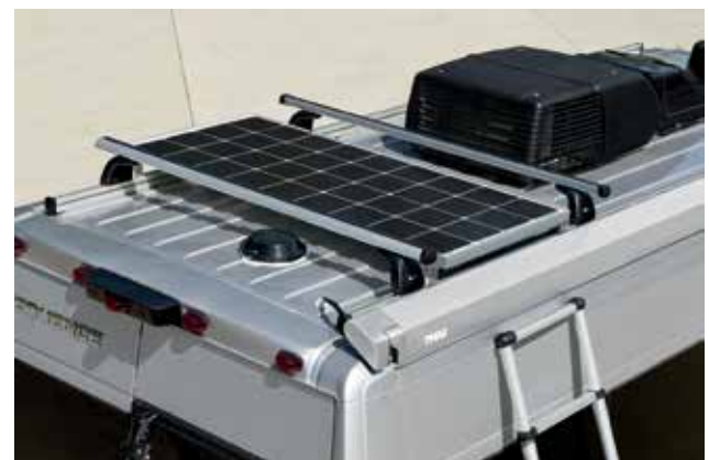
Installation typique de panneaux solaires
