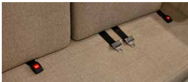
Position normale des ceintures de sécurité dans un coin-repas ou dans un coin-salon
