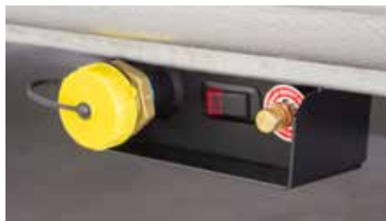
Panneau d'accès au propane positionné le long du côté inférieur gauche du véhicule
