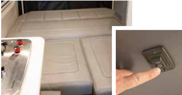
Banquette motorisée et interrupteur d'actionnement. Pour certains modèles, la banquette arrière est à commande manuelle uniquement.
