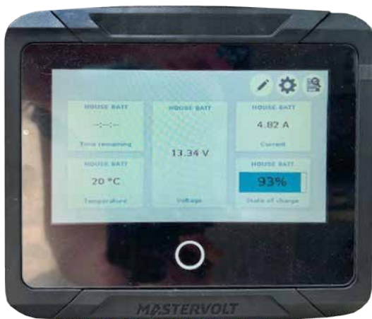
Illustration du panneau de commande Mastervolt en mode moniteur de batterie
