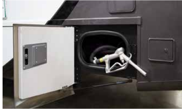
Système de transfert de carburant offert sur les modèles sport TMC Outlaw Classe A
