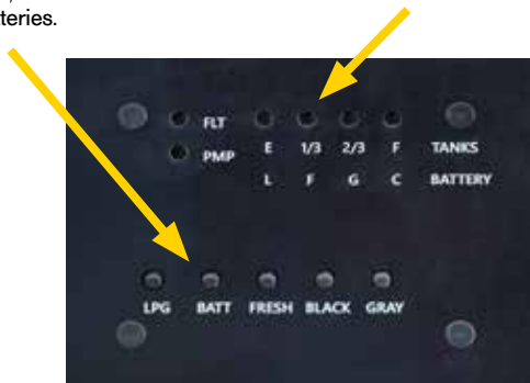
Pavé principal multiplex typique Le contrôle du système électrique est en général au menu de l'écran d'accueil (Service).
