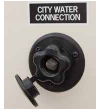
Raccordement de remplissage d'eau municipal typique
