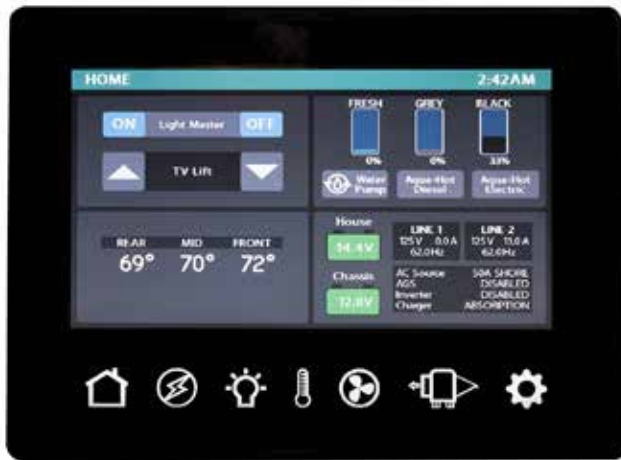
Pavé principal multiplex typique Le contrôle du système électrique est en général au menu de l'écran d'accueil (Service).
