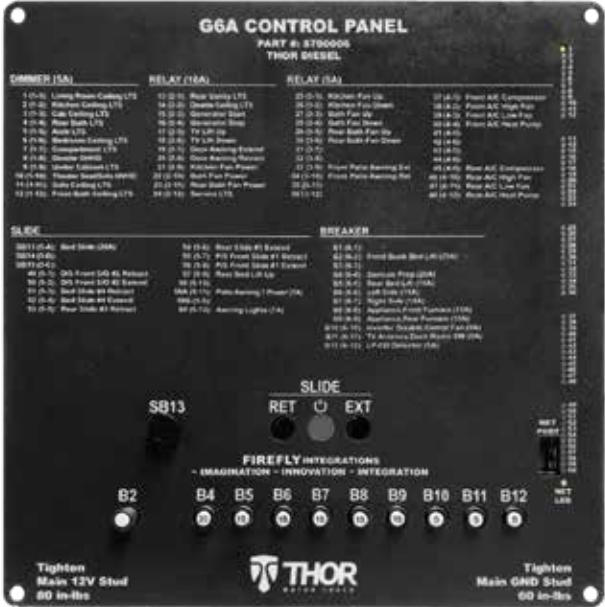
Panneau de disjoncteurs 12 V typiques d'un multiplex Firefly
