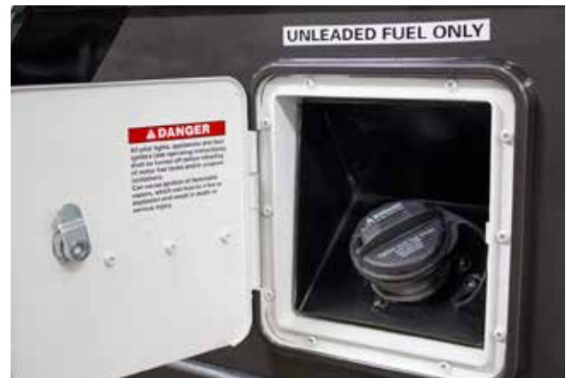
Entrée du réservoir de carburant pour le système de transfert de carburant
