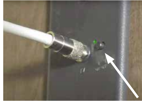
Commutateur de sélection de bouton-poussoir d'antenne/câble avec voyant LED vert
