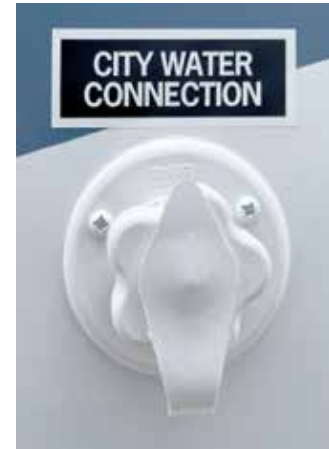
Raccordement de remplissage d'eau municipal typique
