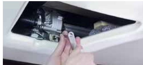
Figure 3. Insérez la manivelle. Tournez dans le sens des aiguilles d'une montre pour lever le lit et dans le sens inverse des aiguilles d'une montre pour abaisser le lit.
