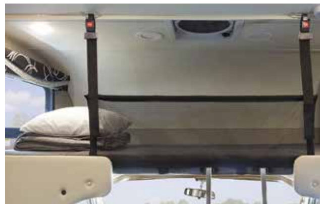
Filet de sécurité pour couchette supérieure typique. En option ou installé par le concessionnaire.
