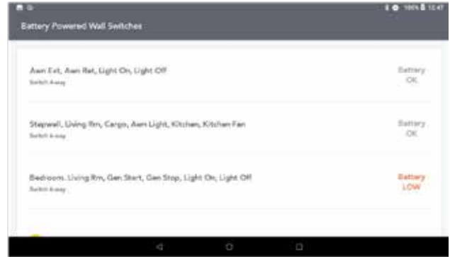
Réglages des commutateurs muraux alimentés par batterie. BAS indique que la pile du commutateur mural doit être remplacée.
