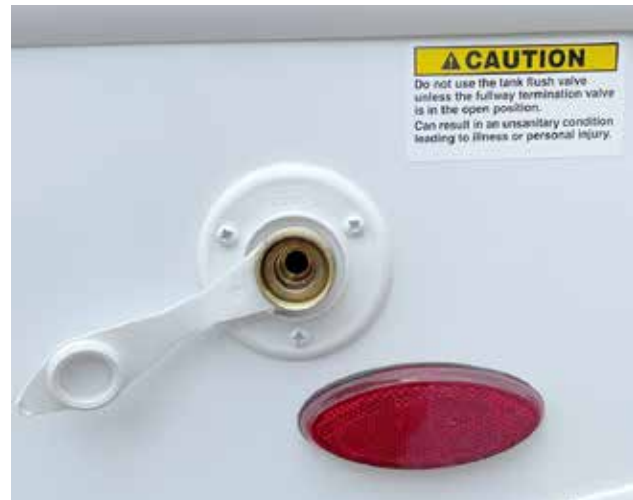
Port de rinçage de réservoir noir typique situé sur le côté gauche de l'autocaravane.
