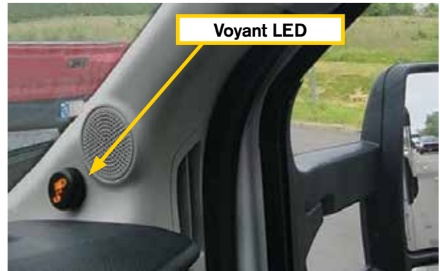
Voyant LED d'angle mort monté sur les montants 'A' gauche et droit du véhicule
