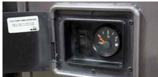
Interrupteur de pompe à carburant et jauge de carburant pour le système de transfert de carburant
