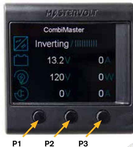
Moniteur et télécommande d'onduleur Mastervolt SmartRemote
