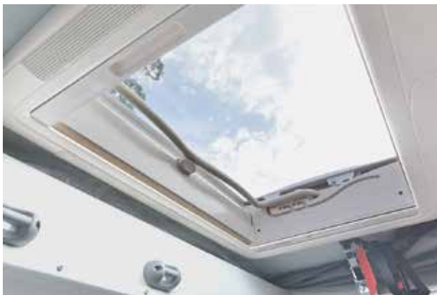
Puits de lumière et pare-soleil intégré
