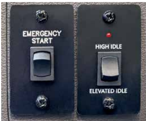
Contrôle de régime de ralenti Ford Transit (droite)
