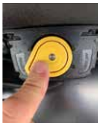
Relais de sécurité tourné à la position de service. Enfoncez le centre pour enclencher le relais.
