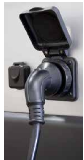
Port de connexion typique du cordon d'alimentation de la ligne de rivage
