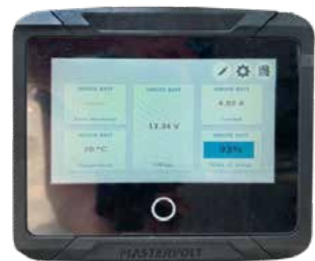
Illustration du panneau de commande EasyView 5 de Mastervolt en mode moniteur de batterie
