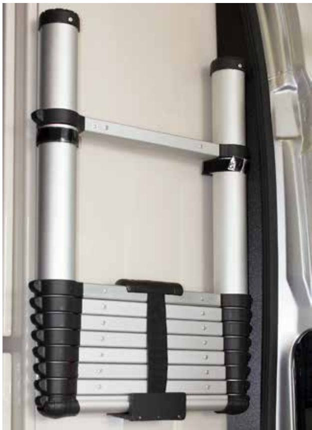
Échelle pliable rangée derrière la porte arrière. Le support magnétique de l'échelle est rangé à l'intérieur de la porte arrière gauche.
