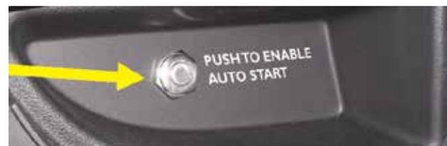
Bouton de démarrage automatique, à gauche du volant
