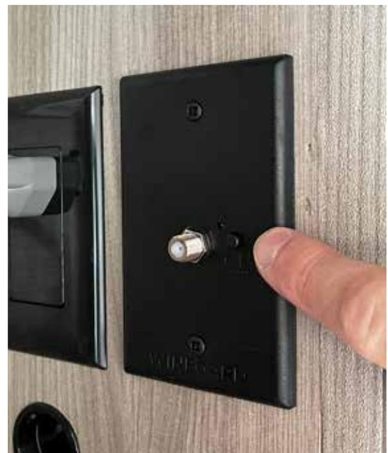
Bouton-poussoir de sélection antenne/câble avec LED verte
