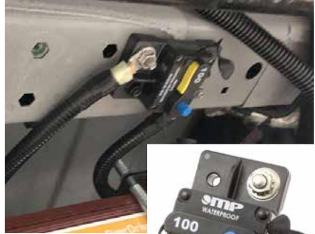
Le disjoncteur typique de l'onduleur de 100 ampères est situé sur un élément du châssis sous le véhicule, près des plateaux de batterie.
