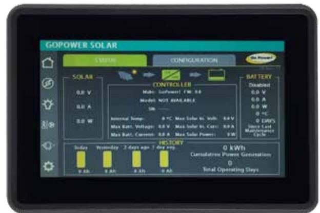
Contrôle solaire intégré. Illustration de l'écran tactile Firefly. L'écran de chargement solaire de votre système multiplex peut différer de cette illustration. Avec le système Firefly, la configuration du contrôle solaire est accessible soit par un onglet de menu (configuration), soit par un bouton de configuration.
