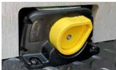
Relais de sécurité du système à batterie Li-ion
