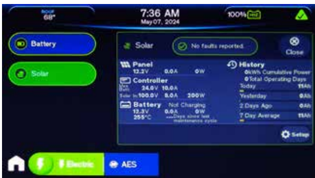
Figure 3 : Appuyer sur le bouton « Solar » (Solaire) affiche l'état du système de charge solaire.
