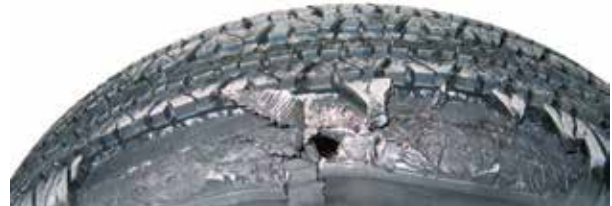
Le sous-gonflage et le surgonflage peuvent entraîner de graves défaillances des pneus
