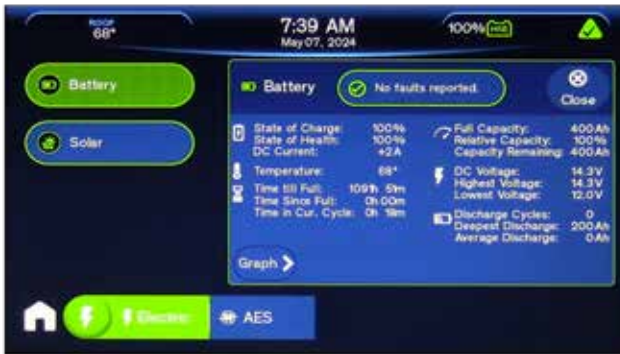
Figure 1 : Détails du SOC de la batterie.
