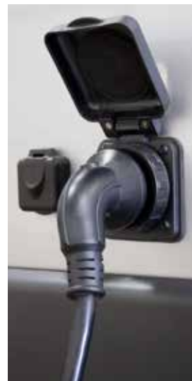
Port de connexion typique du cordon d'alimentation de la ligne de rivage
