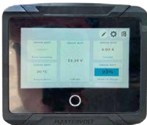
Panneau de commande Mastervolt en mode moniteur de batterie
