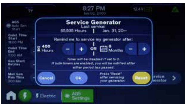
Figure 3: Écran de rappel d'entretien de la génératrice.
