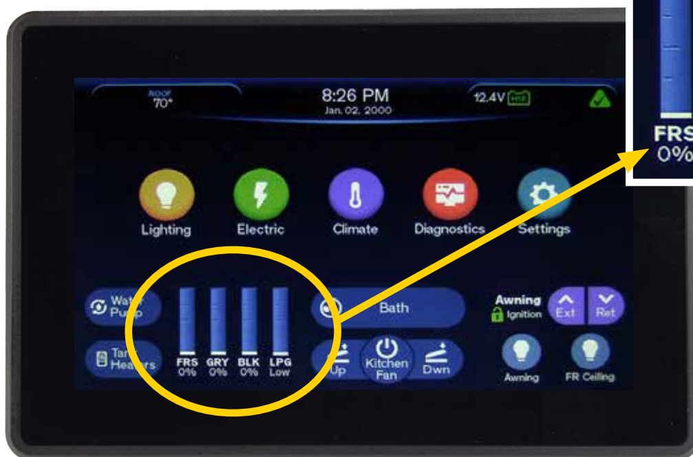
Écran tactile multiplex illustrant l'affichage de surveillance du réservoir.
