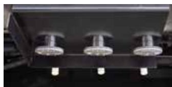
Les vannes de vidange à point bas se trouvent généralement sous le bas de caisse côté gauche
