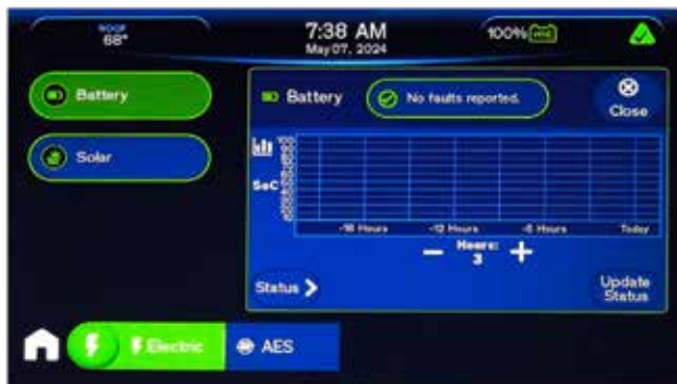
Figure 2 : Graphique du SOC d'une batterie sur une période de temps.
