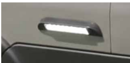
Lampe utilitaire pratique installée du côté conducteur du fourgon aménagé.
