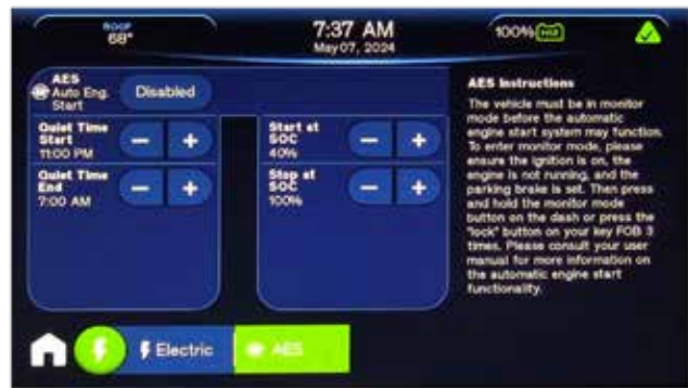
Figure 6 : Écran de paramètres AES.
