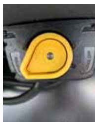
Relais de sécurité enclenché, bloc-batterie alimenté
