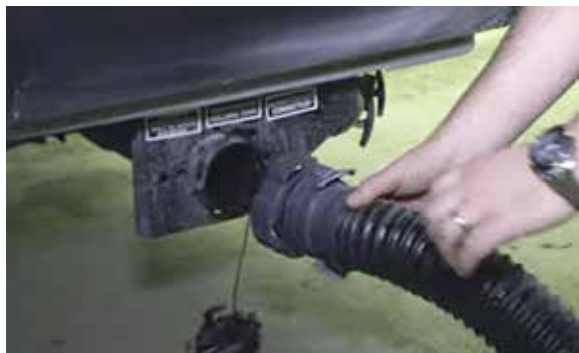
Raccord de tuyau d'évacuation type. Glissez le tuyau sur la sortie et tournez-le pour le verrouiller.
