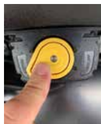
Relais de sécurité tourné à la position de service. Enfoncer le centre pour enclencher le relais.
