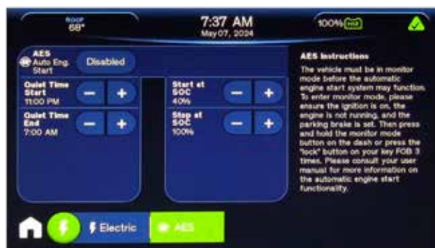
Figure 6 : Écran de paramètres AES.
