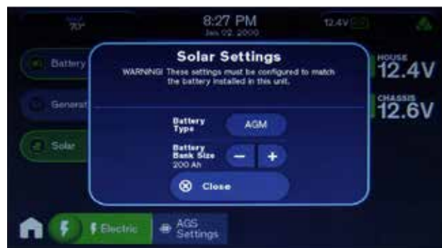
Figure 4 : Écran de réglages solaires.
