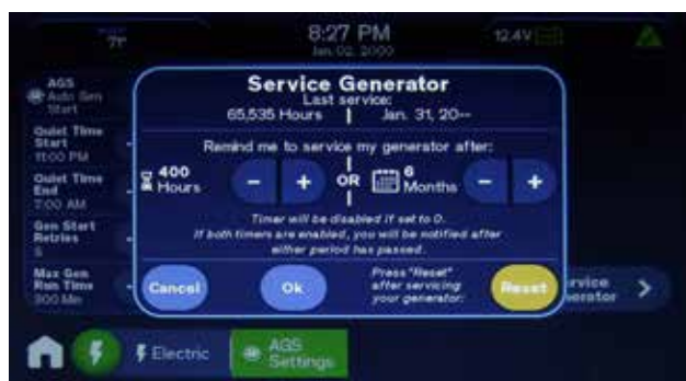
Figure 3: Écran de rappel d'entretien de la génératrice.
