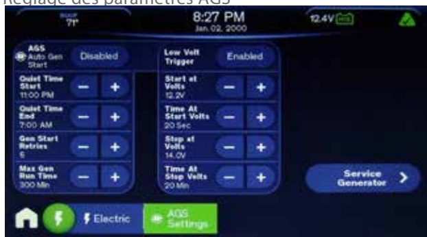
Figure 4: Écran de réglages AGS.
