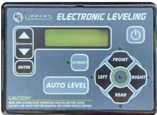
Panneau de commande de nivellation typique (ci-dessus), qui peut contenir un écran LCD. Bien que de style différent, tous les panneaux du système de mise à niveau LCI fonctionnent de façon très similaire les uns aux autres. Assemblage de la pompe hydraulique (ci-dessous).
