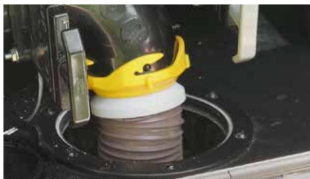
Tuyau d'égout raccordé à la sortie des eaux usées de l'autocaravane.
