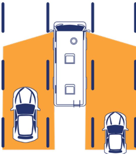
Le système de détection d'angle mort est programmé pour détecter les véhicules motorisés approuvés par le Ministère des Transports (DOT) : motos, voitures et camions. Il ne détecte pas les piétons, les vélos et les animaux.
