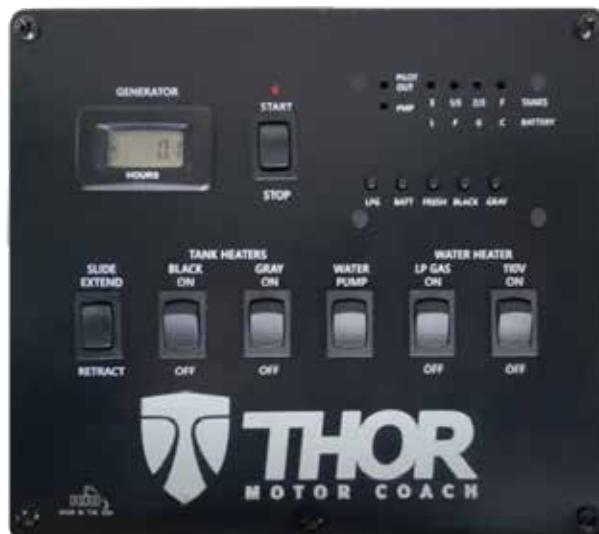
Le commutateur de commande de coulisse installé sur votre autocaravane peut être situé sur le panneau principal du système (illustré ci-dessus) ou sur l'écran du menu Coulisses/Auvents d'un panneau tactile multiplex (ci-dessous). Certains plans de sol auront des commutateurs de déploiement et de rétraction de la section coulissante montés sur un mur près de la section coulissante.
