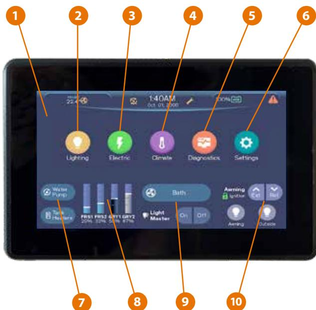
**1 ACCUEIL :** L'écran du menu Accueil est la principale section d'accès à tous les sous-menus du système multiplex. Il affiche aussi les réglages de température du climatiseur, une horloge, la date, l'état de la batterie auxiliaire, une alarme d'erreur d'alimentation électrique à quai et l'accès à une fonction de recherche du système.
