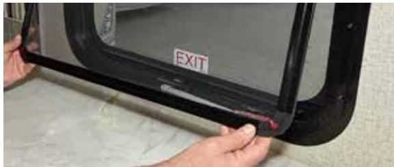
2. Poussez la poignée rouge vers le cadre, puis levez-la pour la sortir du loquet. Les différents modèles de loquets de fenêtre d'évacuation sont rouges et désignés clairement par une étiquette « Exit » (Sortie).
