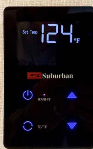
Chauffe-eau sans réservoir Panneau de commande de l'utilisateur (UCP) monté sur une paroi de la salle de bains.
