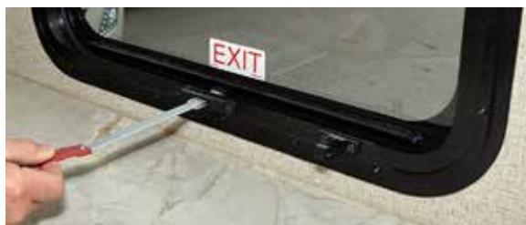
4. Poussez la poignée pour ouvrir la fenêtre. Au besoin, poussez la vitre pour éloigner la fenêtre du joint de cadre. Continuez à pousser la poignée jusqu'à ce qu'elle dépasse entièrement la gorge dans le cadre de fenêtre.
