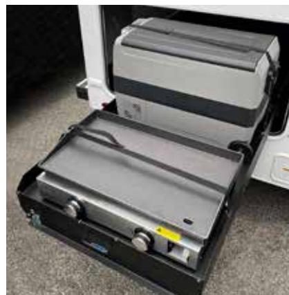
Monté sur un plateau rétractable pratique (avec le gril à gaz), le réfrigérateur/congélateur 12 volts de 40 quart contient deux zones de refroidissement et des paniers de rangement régulés en température. Le séparateur de zone peut être retiré pour créer une seule grande zone de refroidissement ou de congélation.
