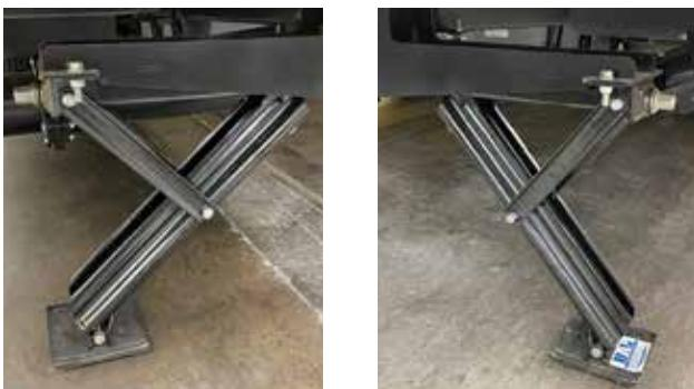
Vérins de stabilisateur électrique gauche et droite ordinaires. Pour la plupart des systèmes, les vérins gauche et droit fonctionnent indépendamment.
