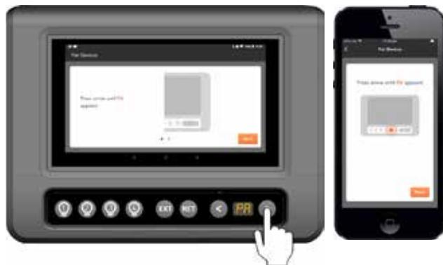
3. Lorsque < PA > apparaît à l'écran, appuyez sur le bouton EXT pour lancer le processus d'appairage au nœud. < PA > clignote pendant 30 secondes maximum ou jusqu'à ce qu'un appareil soit connecté.
