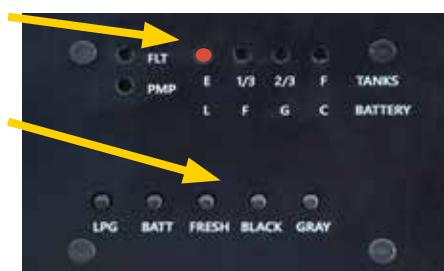
Affichage du niveau du réservoir à DEL du panneau de contrôle.
