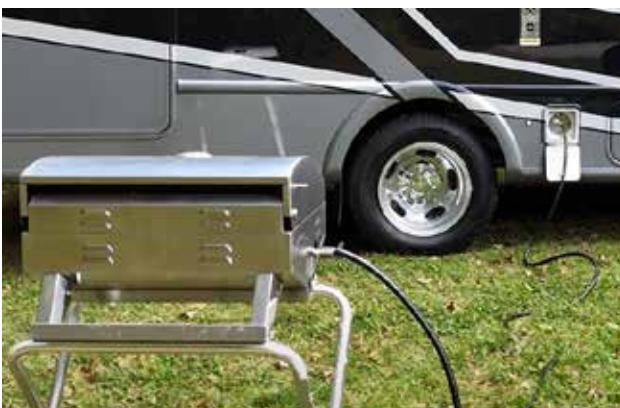
Même s'il est conçu pour une grande variété d'utilisations de GPL en extérieur, l'orifice de connexion GPL externe fournit une source de connexion GPL particulièrement pratique pour les plaques chauffantes au gaz.
