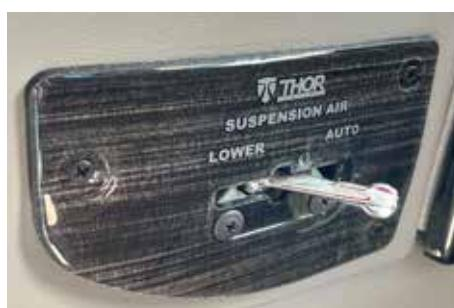
Levier de commande de suspension pneumatique
