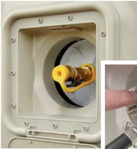
(Au-dessus) Orifice de raccord de propane externe typique. (Droite) vanne d'arrêt manuel.
