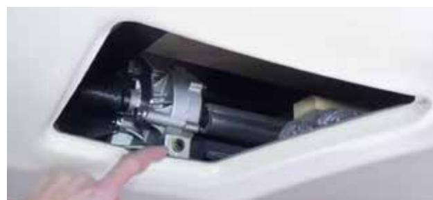
Figure 2. Prise d' entraînement moteur.
