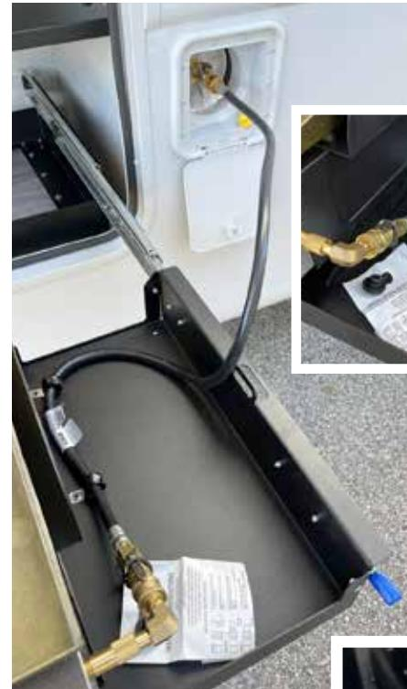
Connexions typiques de tuyaux de gaz et mécanismes de verrouillage du plateau.
