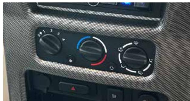
Commandes typiques chauffage et climatisation, tableau de bord Classe A
