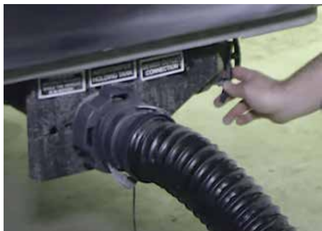
Les vannes de terminaison sont généralement situées sur le côté gauche de l'autocaravane. Les camping-cars de classe B équipés de toilettes à cassette ne seront pas dotés d'une vanne d'arrêt des eaux usées.
