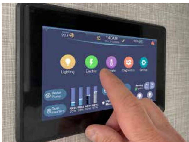
Pavé principal multiplex typique. Les fonctionnalités varient en fonction du modèle et de l'agencement.
