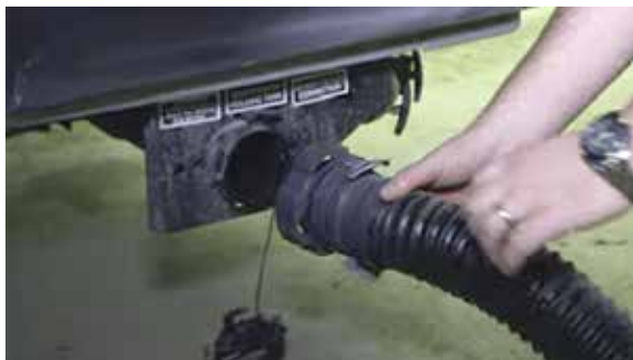
Raccord de tuyau d'évacuation type. Glissez le tuyau sur la sortie et tournez-le pour le verrouiller.
