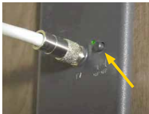
Bouton-poussoir de sélection antenne/câble avec LED verte
