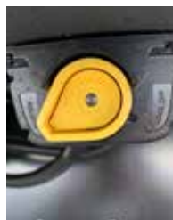
Relais de sécurité enclenché, bloc-batterie alimenté
