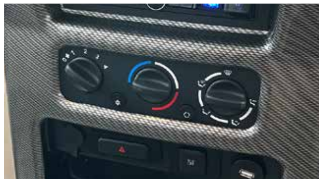
Commandes typiques chauffage et climatisation, tableau de bord Classe A
