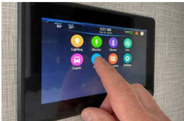
Pavé principal multiplex typique. Les fonctionnalités varient en fonction du modèle et du plan de surface.
