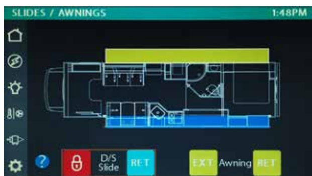
Le commutateur de commande de coulisse installé sur votre autocaravane peut être situé sur le panneau principal du système (illustré ci-dessus) ou sur l'écran du menu Coulisses/Auvents d'un panneau tactile multiplex (ci-dessous).
