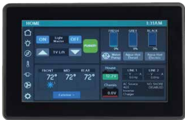
Panneaux d'écran tactile typiques ; Firefly (ci-dessus) et BMPPro (ci-dessous). Les fonctionnalités varient en fonction du modèle et du plan de surface de l'autocaravane.
