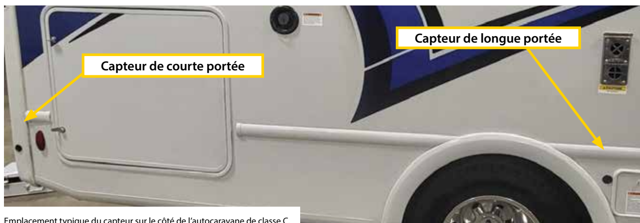
Emplacement typique du capteur sur le côté de l'autocaravane de classe C.
