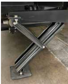
Vérins de stabilisateur électrique gauche et droite ordinaires. Pour la plupart des systèmes, les vérins gauche et droit fonctionnent indépendamment.
