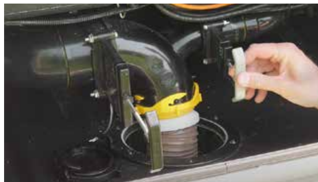
Fermeture des vannes d'extrémité ; fermez d'abord la vanne grise, puis la vanne noire.
