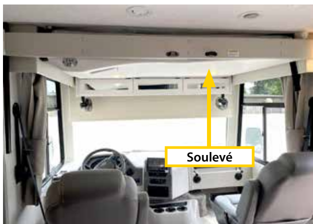
Couchette supérieure Euroloft en position relevée ou rangée (ci-dessus). Couchette EuroLoft en position abaissée (ci-dessous).
