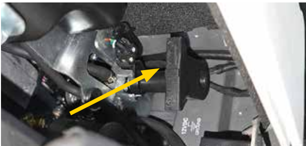
Vanne de sélection de carburant. Tournez pour utiliser de l'essence ou du propane.
