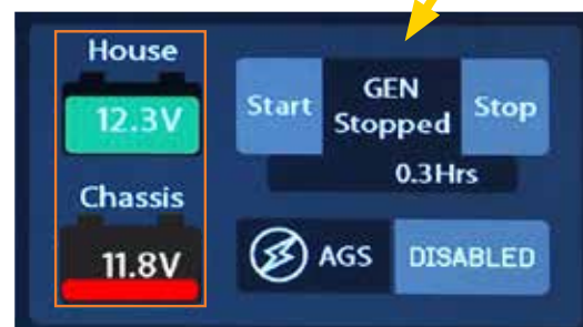
Pavé principal multiplex typique. Le contrôle du système électrique basique est en général au menu de l'écran principal (Accueil).
