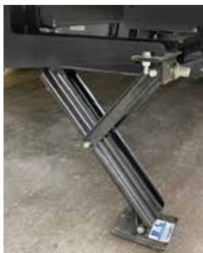
Vérins de stabilisateur électrique gauche et droite ordinaires. Pour la plupart des systèmes, les vérins gauche et droit fonctionnent indépendamment.
