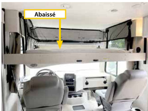
Couchette supérieure Euroloft en position relevée ou rangée (ci-dessus). Couchette EuroLoft en position abaissée (ci-dessous).
