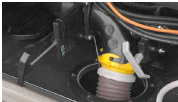
Vanne d'extrémité du réservoir d'eaux usées en position OUVRETE.
