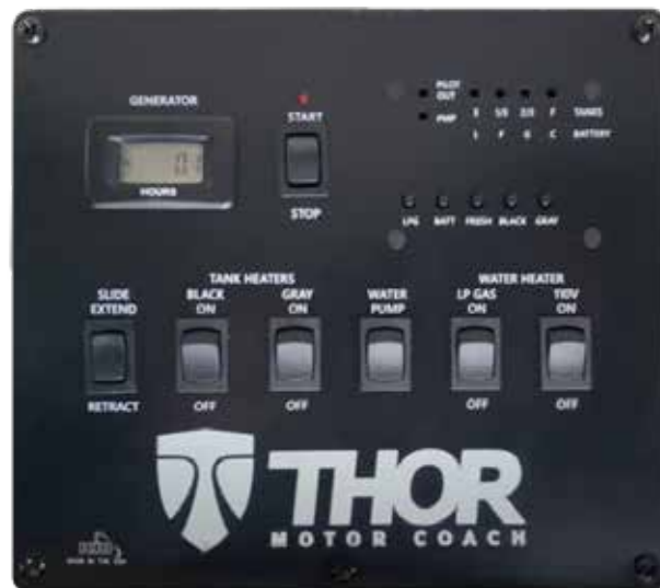
Le commutateur de commande de coulisse installé sur votre autocaravane peut être situé sur le panneau principal du système (illustré ci-dessus) ou sur l'écran du menu Coulisses/Auvents d'un panneau tactile multiplex (ci-dessous).
