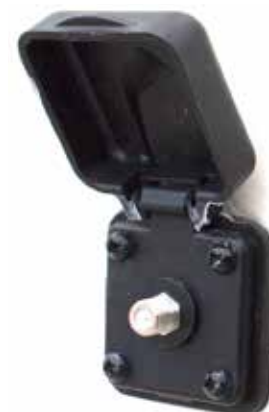
Branchement typique de la télévision par câble situé sur le côté conducteur de l'autocaravane. Sur certains modèles d'autocaravane, les branchements pour câbles coaxiaux sont situés sur le panneau d'eau douce ou à l'intérieur d'une zone de rangement côté gauche.
