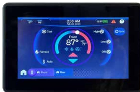
Panneaux de commande multiplex typiques avec affichage de la régulation du climat
