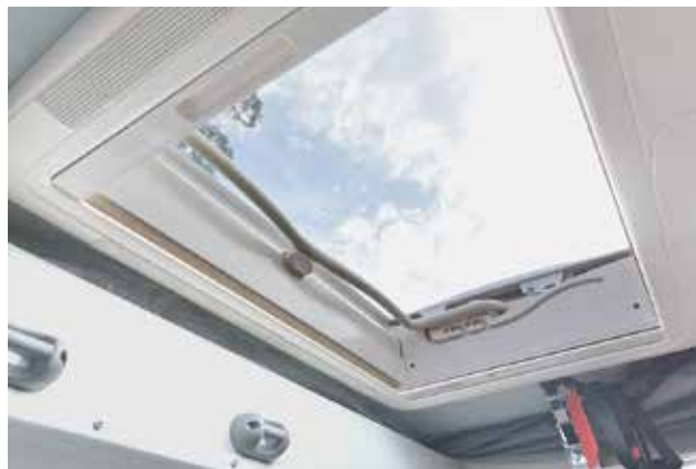
Puits de lumière et pare-soleil intégré
