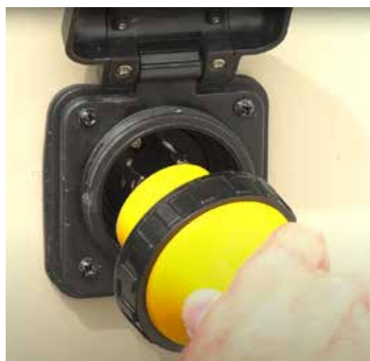
Raccorder le cordon secteur à l'autocaravane en faisant glisser son connecteur sur les broches de la prise mâle; le tourner un peu vers la droite, puis engager la bague de blocage et fixer le cordon à l'autocaravane.
