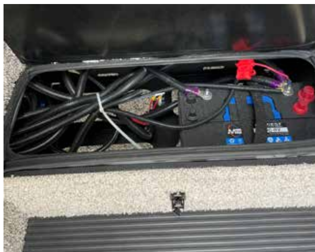
Emplacement typique de la batterie d'un autocaravanes de classe C (sous la marche d'entrée)
