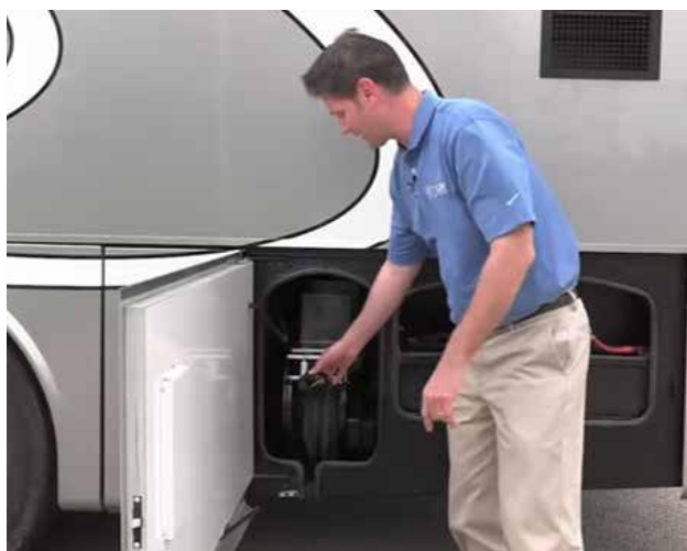
Cordon secteur 50 A sur l'enrouleur électrique.
