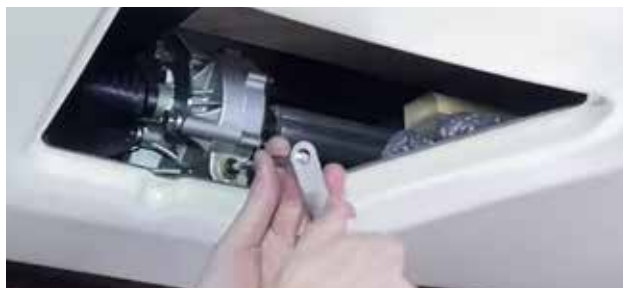
Figure 3. Insérez la manivelle. Tournez dans le sens des aiguilles d'une montre pour lever le lit et dans le sens inverse des aiguilles d'une montre pour abaisser le lit.
