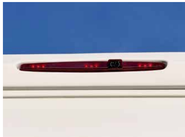
Caméra de vision arrière classique située le long du bord supérieur arrière de l'autocaravane.
