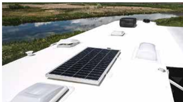
Panneau solaire typique monté sur le toit
