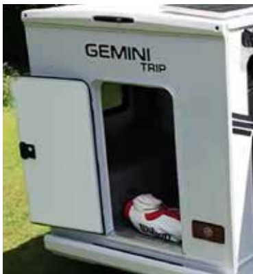
Porte de chargement arrière typique et anneau(x) d'arrimage du chargement. La photo illustre le lit arrière en position de rangement (vers le haut).
