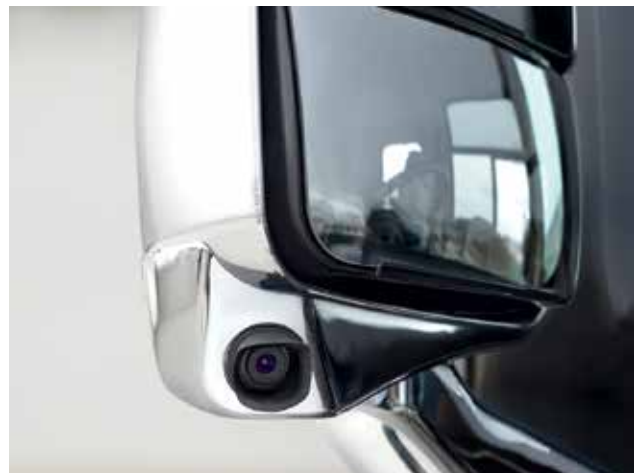
Les rétroviseurs sont un élément essentiel pour la conduite sécuritaire d'une autocaravane. La photo suivante montre un rétroviseur convexe avec caméra latérale.
