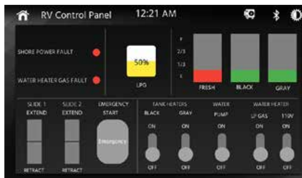
Illustration de l'écran principal de commande Touch N' Go. Les fonctions de surveillance et de contrôle peuvent varier selon les fonctions standard et optionnelles installées.
