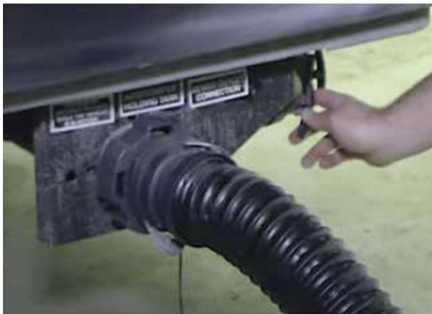
Les vannes de terminaison sont généralement situées sur le côté gauche de l'autocaravane. Les camping-cars de classe B équipés de toilettes à cassette ne seront pas dotés d'une vanne d'arrêt des eaux usées.
