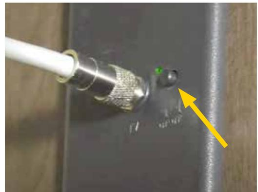
Bouton-poussoir de sélection antenne/câble avec LED verte
