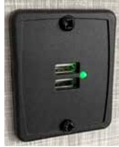
Les stations de charge USB sont stratégiquement situées dans l'autocaravane pour faciliter l'utilisation des appareils électroniques.
