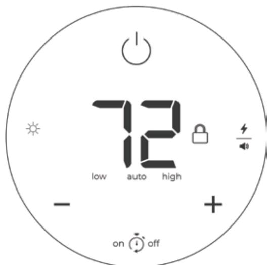
Panneau de commande du chauffage infrarouge
