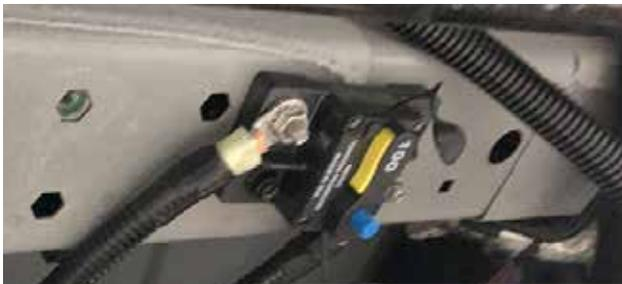
Le disjoncteur typique de l'onduleur de 100 ampères est situé sur un élément du châssis sous le véhicule, près des plateaux de batterie.
