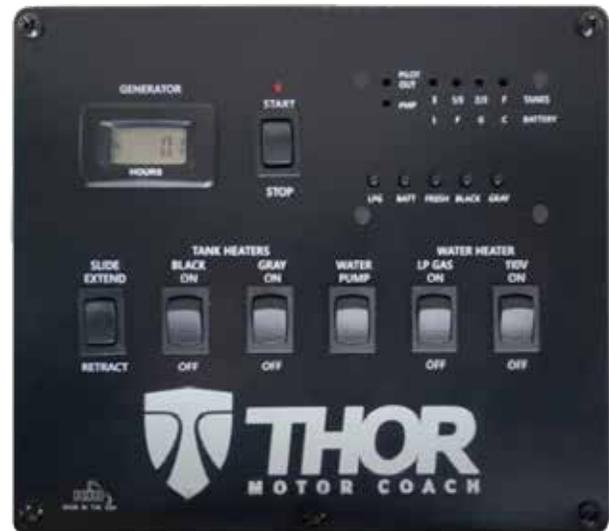
Le commutateur de commande de coulisse installé sur votre autocaravane peut être situé sur le panneau principal du système (illustré ci-dessus) ou sur l'écran du menu Coulisses/Auvents d'un panneau tactile multiplex (ci-dessous).
