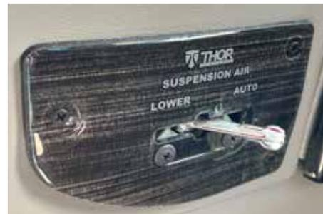
Levier de commande de suspension pneumatique
