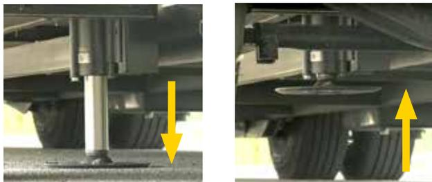
Crics hydrauliques en position BAS et HAUT (ci-dessus). Ensemble de pompe hydraulique (ci-dessous).
