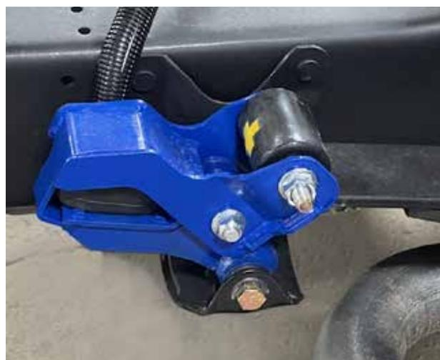
Les ressorts de compression en caoutchouc et une barre stabilisatrice apportent à votre autocaravane TMC équipée d'un moteur SmoothTech une plus grande tenue et un meilleur confort de conduite.
