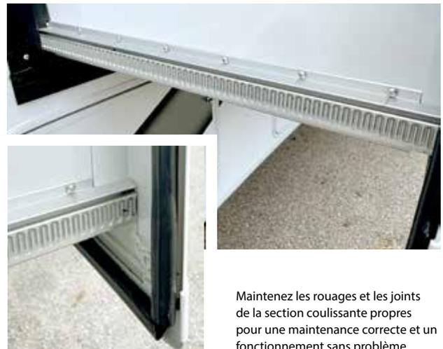
Maintenez les rouages et les joints de la section coulissante propres pour une maintenance correcte et un fonctionnement sans problème
