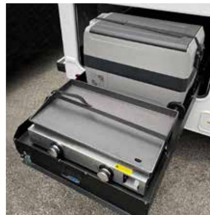
Monté sur un plateau rétractable pratique (avec le gril à gaz), le réfrigérateur/congélateur 12 volts de 40 quarts contient deux zones de refroidissement et des paniers de rangement réglés en température. Le séparateur de zone peut être retiré pour créer une seule grande zone de refroidissement ou de congélation.
