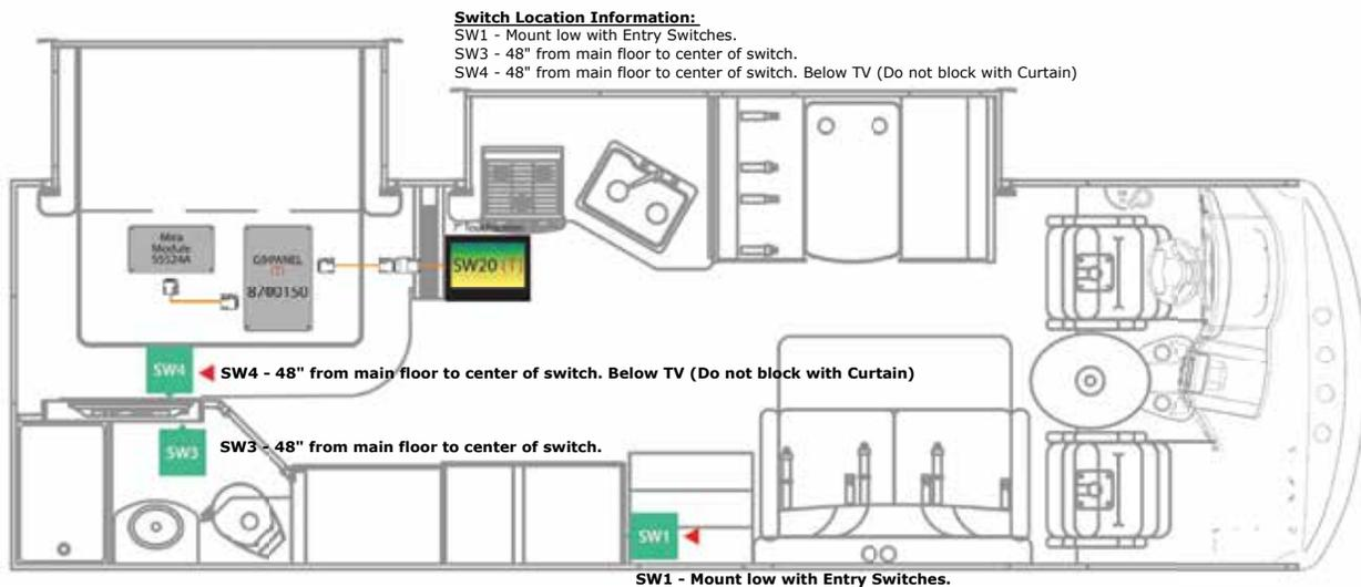
Illustration de câblage (ci-dessous) d'un système multiplex typique ; consistant en un panneau de commande d'écran tactile principal, des commutateurs sans fil et des panneaux de commande d'alimentation et des modules électriques.
