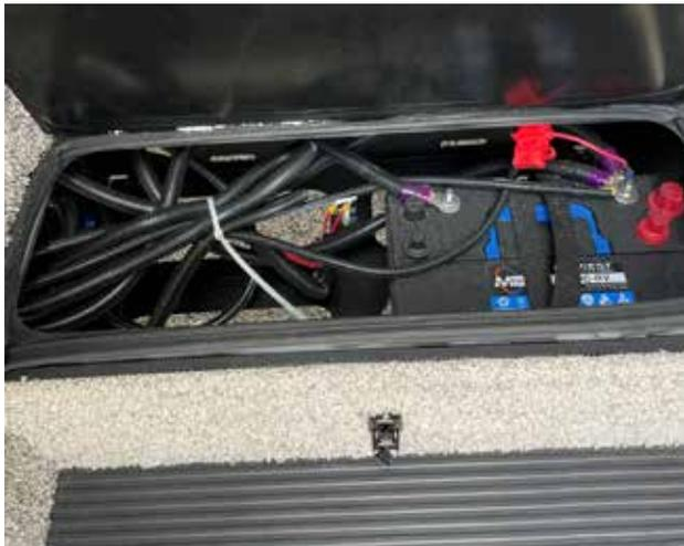
Emplacement typique de la batterie d'un autocaravanes de classe C (sous la marche d'entrée)
