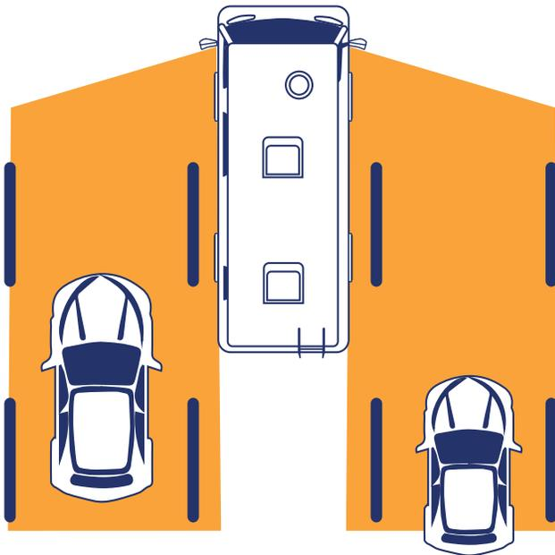
Le système de détection d'angle mort est programmé pour détecter les véhicules motorisés approuvés par le Ministère des Transports (DOT) : motos, voitures et camions. Il ne détecte pas les piétons, les vélos et les animaux.
