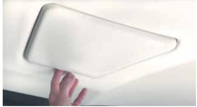
Figure 1. Panneau d'accès au moteur.
