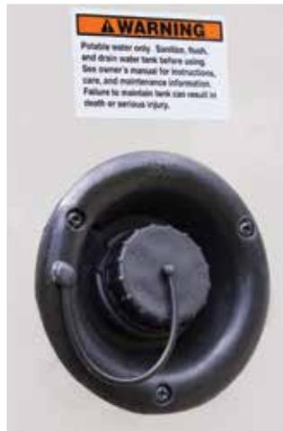
Remplissage par gravité d'eau douce typique. Certains bouchons de remplissage peuvent se trouver derrière un panneau d'accès verrouillable.
