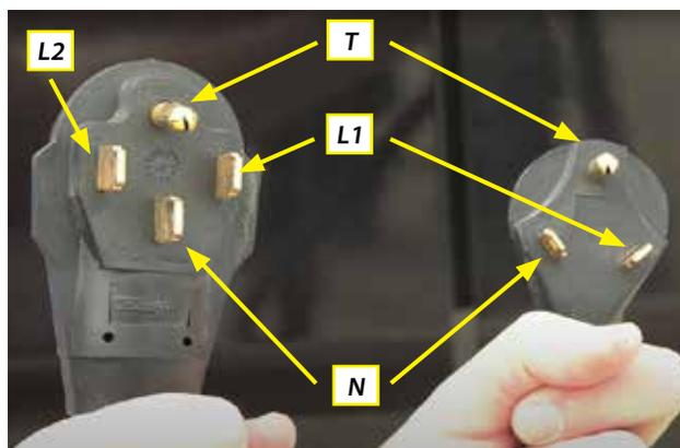
T = Terre      L1 = Ligne 1 (tension neutre-terre mesurée : 120 V CA)
