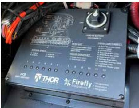
Commutateur principal de batterie situé sur le tableau des disjoncteurs 12 volts.
