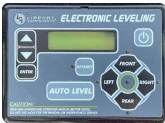
Panneau de commande de nivellement typique (ci-dessus), qui peut contenir un écran LCD. Bien que de style différent, tous les panneaux du système de mise à niveau LCI fonctionnent de façon très similaire les uns aux autres. Assemblage de la pompe hydraulique (ci-dessous).
