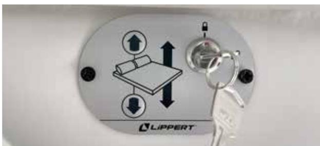
4. APPUYEZ sur le commutateur de position en forme de flèche et MAINTENEZ ENFONCÉ. Un voyant LED vert sur le panneau de commande s'allume dans le sens de déplacement du lit. Le lit s'arrête automatiquement lorsqu'il atteint la position d'arrêt prééglée.
