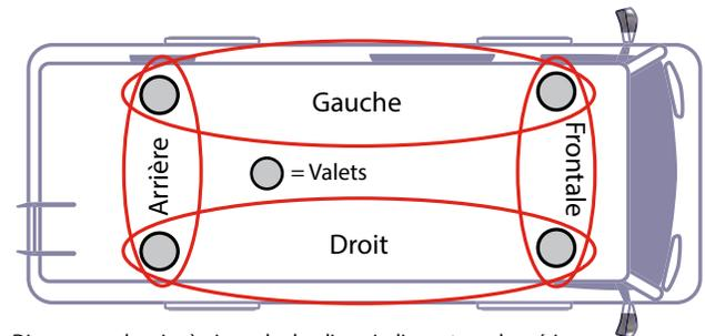
Diagramme de mise à niveau hydraulique indiquant que les vérins fonctionnent par paires.
