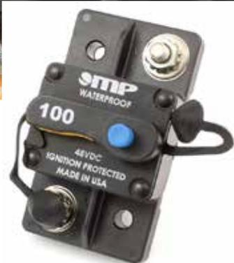
**REMARQUE :** Un levier jaune déployé indique qu'un disjoncteur s'est déclenché. Localisez et corrigez la surcharge, puis remplacez le levier dans le boîtier. Le bouton bleu est un dispositif de test des disjoncteurs. En appuyant sur le bouton bleu, l'onduleur se déconnecte de la (des) batterie(s).
