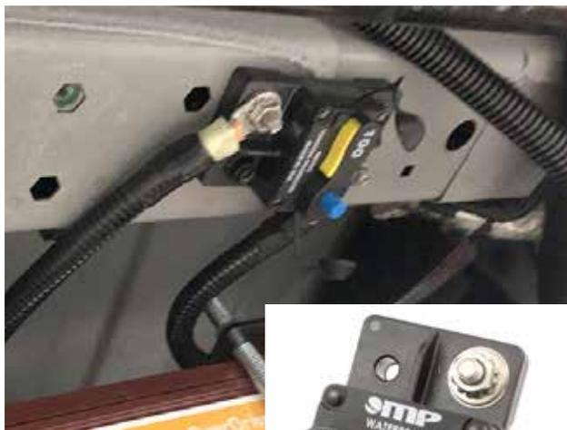
Le disjoncteur typique de l'onduleur de 100 ampères est situé sur un élément du châssis sous le véhicule, près des plateaux de batterie.
