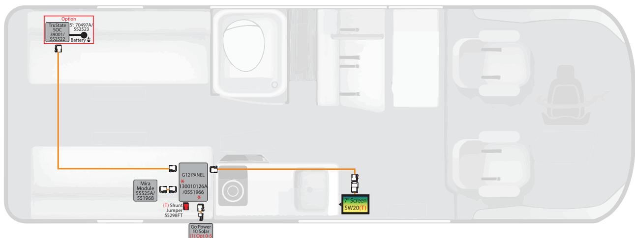
Illustration de câblage (ci-dessus) d'un système multiplex Firefly typique, composé d'un panneau de commande principal à écran tactile, de commutateurs sans fil et d'un tableau de contrôle électrique principal.
