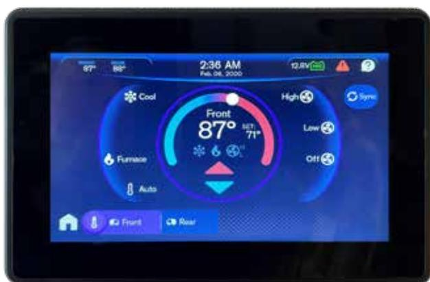
Réglez la température climatisée souhaitée dans le menu Climatisation sur le contrôleur d'écran tactile multiplex.
