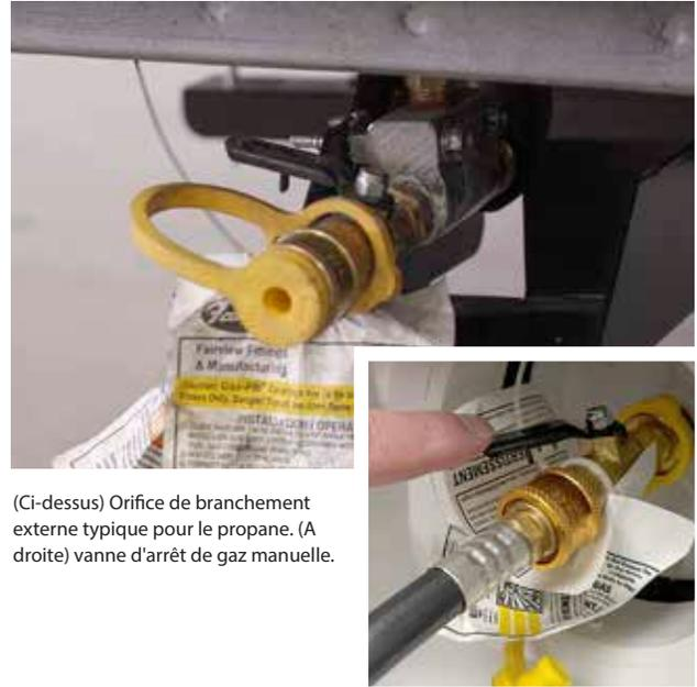
(Ci-dessus) Orifice de branchement externe typique pour le propane. (A droite) vanne d'arrêt de gaz manuelle.
