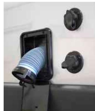
Raccord de remplissage d'eau de ville, ainsi qu'une chambre de stockage pour le tuyau d'égout. Cette image pour référence seulement. Les ports d'eau sur les camping-cars de classe B varient en type et en emplacement en raison des plans d'étage et des caractéristiques.
