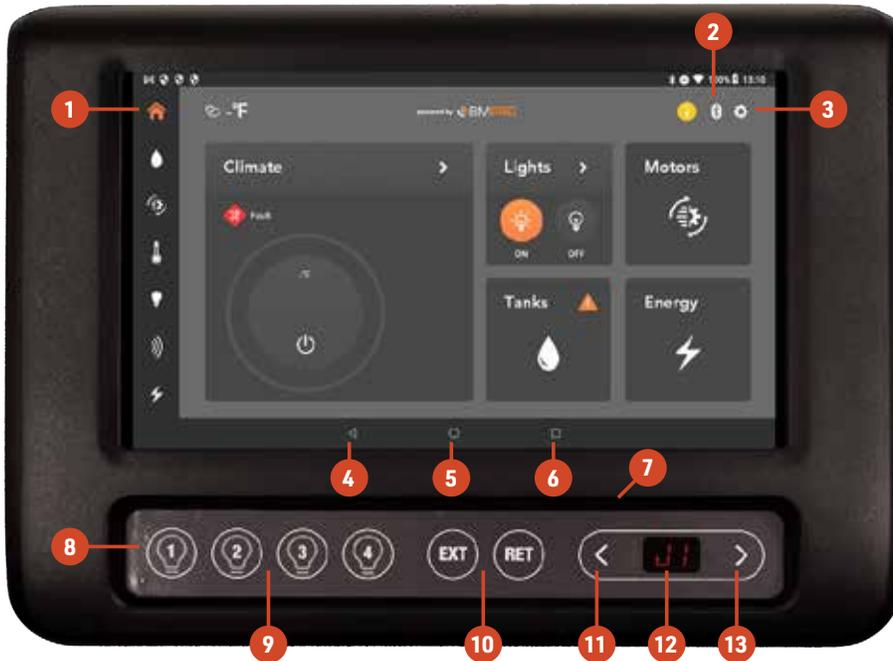
*REMARQUE : les interrupteurs de commande d'éclairage et de moteur (n° 9 et 10) peuvent être actionnés immédiatement après la mise sous tension de l'écran tactile. Il n'est pas nécessaire d'attendre que l'application principale soit lancée (démarrage).*
