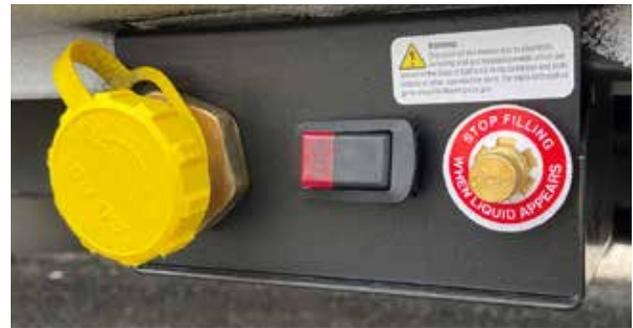
Panneau d'accès au propane positionné le long du côté inférieur gauche du véhicule
