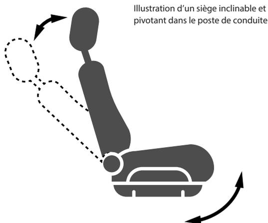
Illustration d'un siège inclinable et pivotant dans le poste de conduite
