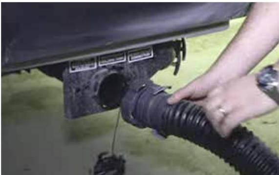
Raccord de tuyau d'évacuation type. Glissez le tuyau sur la sortie et tournez-le pour le verrouiller.
