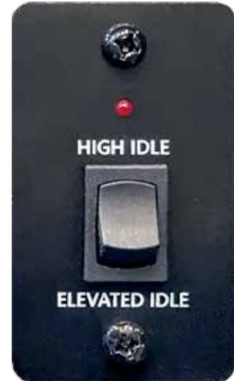
Toutes les autocaravanes TMC de classe B basées sur le Ford Transit (modèles Palladium et Talavera) sont équipées d'un commutateur manuel (activé par le conducteur) de contrôle de la vitesse de ralenti accéléré. Ce commutateur se trouve à côté du commutateur de démarrage d'urgence (pour la fonction E-Start, se reporter à la page 91).
