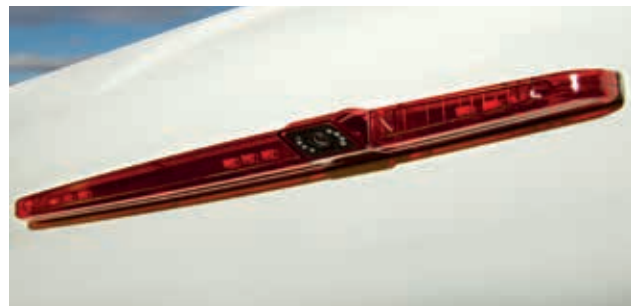
Caméra de vision arrière classique située le long du bord supérieur arrière de l'autocaravane.
