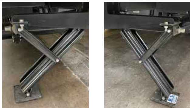
Vérins de stabilisateur électrique gauche et droite ordinaires. Pour la plupart des systèmes, les vérins gauche et droit fonctionnent indépendamment.
