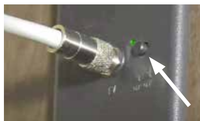
Commutateur de sélection de bouton-poussoir d'antenne/câble avec voyant LED vert
