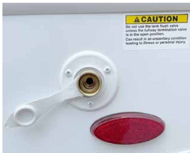
Port de rinçage de réservoir noir typique situé sur le côté gauche de l'autocaravane.
