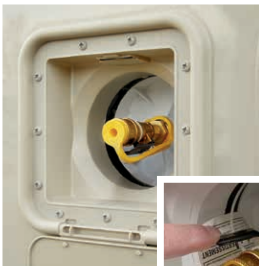
(Au-dessus) Orifice de raccord de propane externe typique. (Droite) vanne d'arrêt manuel.
