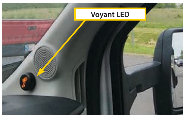
Voyant LED d'angle mort monté sur les montants 'A' gauche et droit du véhicule
