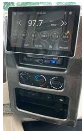
Commandes typiques chauffage et climatisation, tableau de bord Classe A
