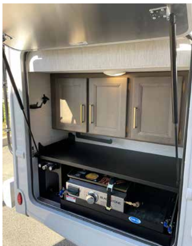
Exemples de cuisines extérieures en option. En fonction des options de plan de surface, les cuisines extérieures peuvent inclure des meubles de rangement, un réfrigérateur, un évier avec eau chaude et froide (voir ci-dessus), grill à gaz rétractable, pulvérisateur d'eau avec eau chaude et froide (voir ci-dessous).
