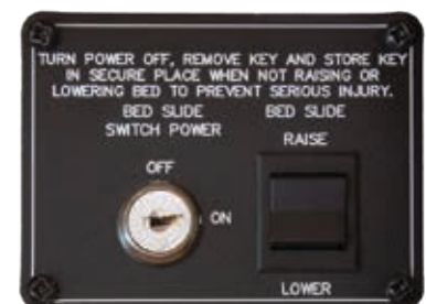
Figure 3. Les commandes du lit électrique avant d'un multiplex se trouvent en général dans le menu des systèmes coulissants/auvents; certains multiplex ont également une commande murale pratique.
