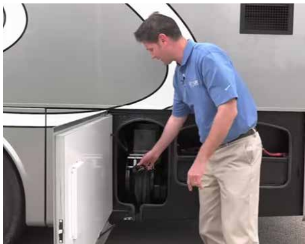
Cordon secteur 50 A sur l'enrouleur électrique.
