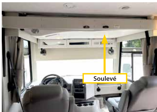
Couquette supérieure Euroloft en position relevée ou rangée (ci-dessus). Couquette EuroLoft en position abaissée (ci-dessous).
