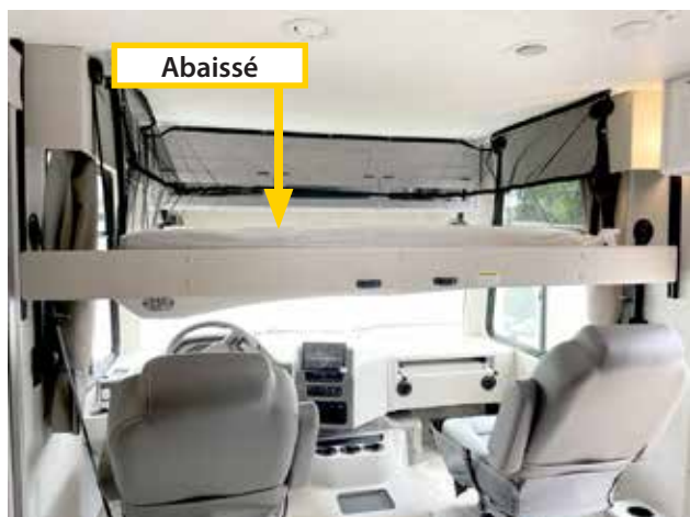
Couquette supérieure Euroloft en position relevée ou rangée (ci-dessus). Couquette EuroLoft en position abaissée (ci-dessous).
