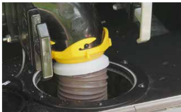
Tuyau d'égout raccordé à la sortie des eaux usées de l'autocaravane.
