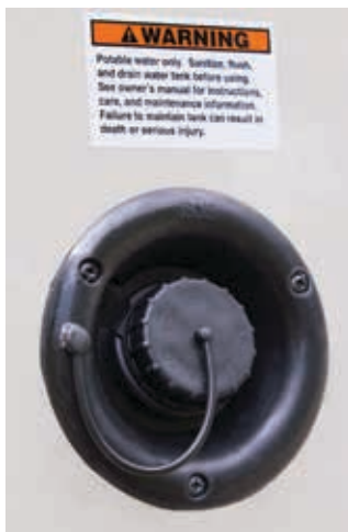
Remplissage par gravité d'eau douce typique. Certains bouchons de remplissage peuvent se trouver derrière un panneau d'accès verrouillable.
