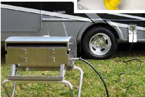
(Au-dessus) Orifice de raccord de propane externe typique. (Droite) vanne d'arrêt manuel.
