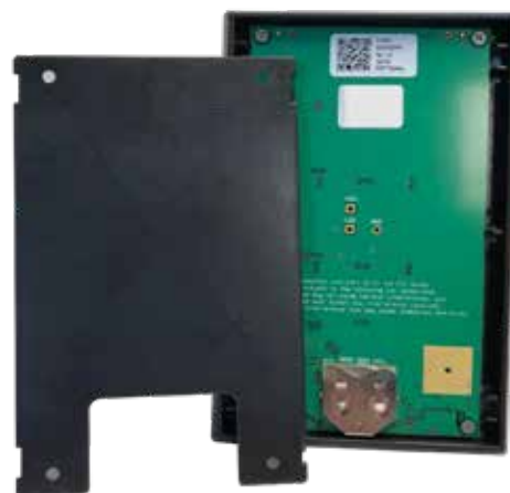
TPanneau de commutation sans fil multiplex typique. Accès au compartiment de la batterie (ci-dessous).
