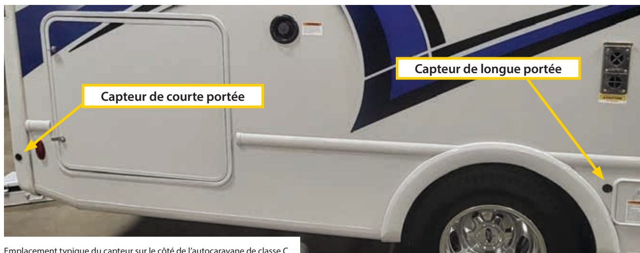
Emplacement typique du capteur sur le côté de l'autocaravane de classe C.
