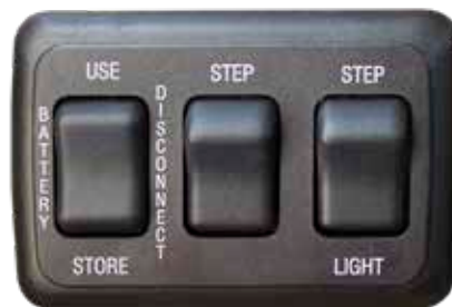
Interrupteur typique (au centre) du marchepied électrique. La configuration varie, mais il sera toujours situé près de la porte d'accès de l'autocaravane.
