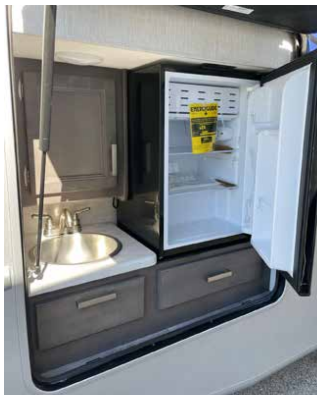
Exemples de cuisines extérieures en option. En fonction des options de plan de surface, les cuisines extérieures peuvent inclure des meubles de rangement, un réfrigérateur, un évier avec eau chaude et froide (voir ci-dessus), grill à gaz rétractable, pulvérisateur d'eau avec eau chaude et froide (voir ci-dessous).
