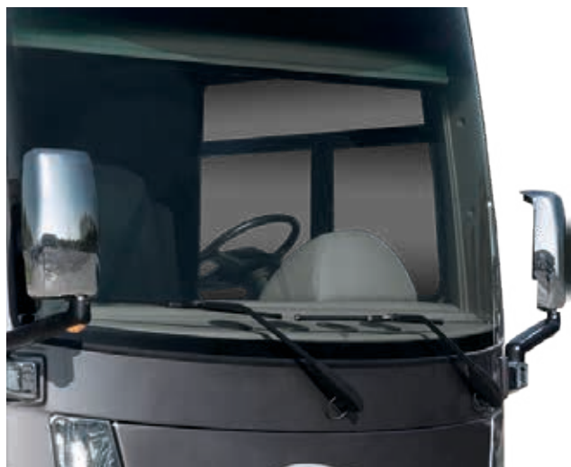
Les rétroviseurs sont un élément essentiel pour la conduite sécuritaire d'une autocaravane. La photo suivante montre un rétroviseur convexe avec caméra latérale.
